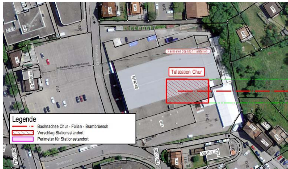
Abb. 11 Minimaler Platzbedarf Talstation Chur für eine geplante Umlaufbahn
